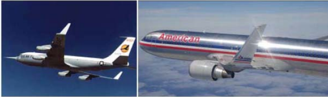
그림. 1 (좌) 1970년대 드라이덴 비행 연구센터의 연구핵심은 항공기의 성능 중심에서 효율 중심으로 이동했다. 그 중 하나의 결과가 윙릿이다. (우) 보잉사는 부드러운 모양의 윙릿을 상업용 여객기에 적용했다. 이로써 약 4~6%의 연료절감효과를 얻을 수 있다.
