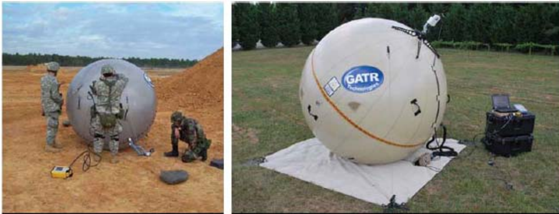
그림. 5 (좌) 군인들이 북 캐롤라이나 지방에서 팽창 가능한 안테나를 설치하고 시험하고 있다. (우) 안테나를 설치하는데는 45분이 소요되고, 해체하는데는 15분이 소요된다. 해체 되었을 때는 안테나를 돌돌 말을 수 있어 침방가방 크기에 들어간다. 전체 무게는 약 90파운드 미만이다.
