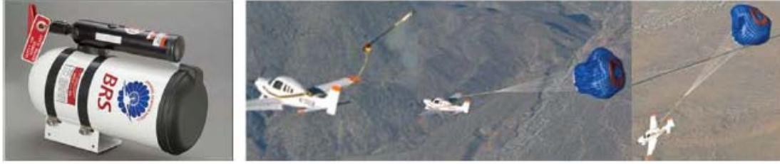
그림. 4 (좌) BRS Aerospace 사의 낙하산 시스템. 소형 항공기 전체를 보호할 수 있으며 펼쳐지는데 1초 미만이 걸린다. 검은 부분이 뚜껑이다. (우) 낙하산이 실제로 펼쳐지는 모습
