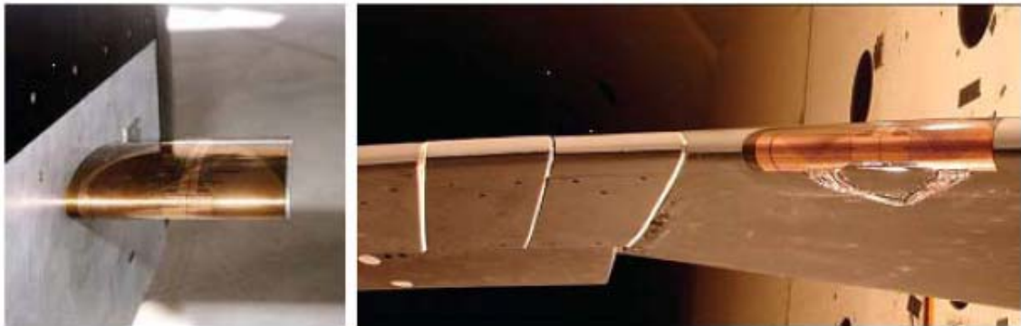
그림. 2 (좌) 드라이덴 비행 연구센터의 F-15B의 장착된 음속 충격파 위치 센서. (우) Tao System사의 센서 어레이.
