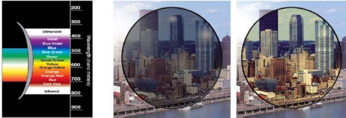
그림. 11 (좌) Eagle eyes 렌즈 필터의 개념도. (우) Eagle eyes 사의 선글라스는 자외선, 보라색, 푸른색을 차단하고, 붉은색, 주황색, 노란색을 강화시켜 유해한 빛을 차단하면서 시각을 선명하게 한다.
